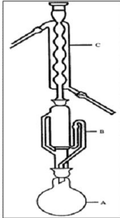
Figura 1 - Aparato de Soxhlet.
